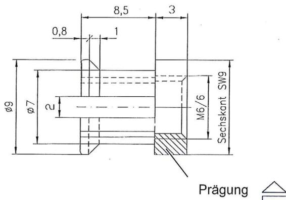
**Sechskantschraube mit angeformter Sperrzahnkopf-Scheibe**
