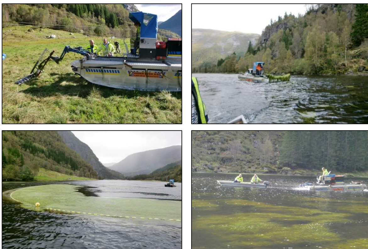
Figur 2. Opprenskingsmetoder og utstyr. Klippemaskinen som blir benyttet virvler opp store mengder plantemateriale som blir fanget opp av en oppsamler på selve klippemaskinen (øverst t.h.), samt av lenser (nederst t.v.).
