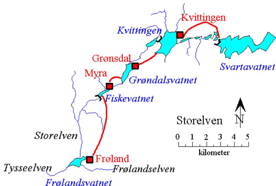
Figur 1.2.1. Reguleringane i dei nedre deler av Storelva. Kraftverka er synt med raude firkantar og raud skrift, medan inntaksmagasina er namngjevne med blå tekst.
