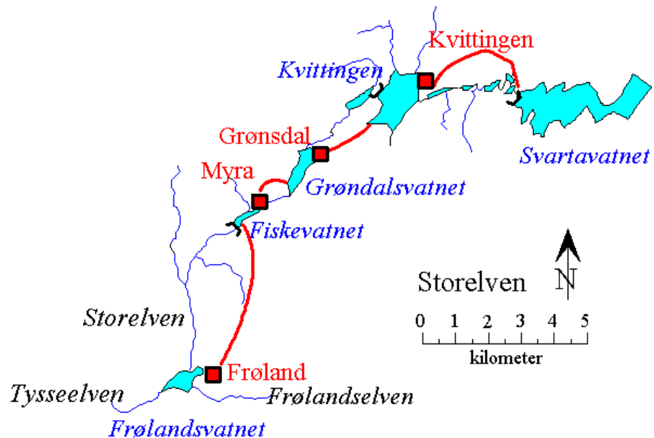
Figur 2.2.1. Reguleringane i dei nedre deler av Storelva. Kraftverka er synt med raude firkantar og raud skrift, medan inntaksmagasina er namngjevne med blå tekst.
