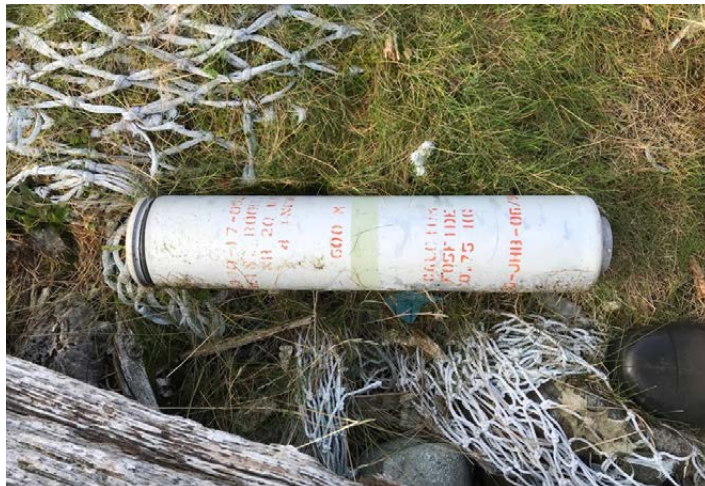
Røykmarkør som inneholder kalsiumfosfid. Lengde: 45–55 cm
