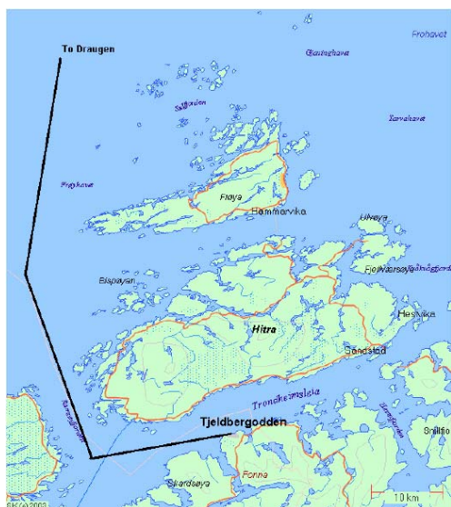
Figur 2-4. Antatt rørledningstrasé mellom Tjeldbergodden og Draugen
