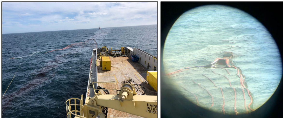
Figur 6-11 MOS Sweeper 50 systemet i operasjon under NOFO øvelse 2018. Oljeemulsjon ble sluppet kontrollert inn i systemet som samler og holder på emulsjon i reduksjonskanalen (foto: NOFO)
