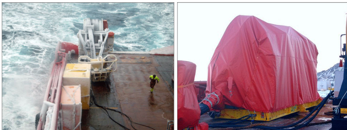
Figur 6-12 Venstre: Utstyr som er i ferd med å bygge islag, høyre: Linse med beskyttelses presenning (BASOP, 2021)
