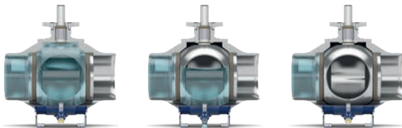
Abbildung 14. „Double Block & Bleed“ – Funktion
