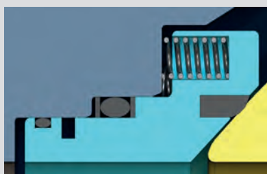
Abb. 3b Sitz PMSW mit Thermoplast
