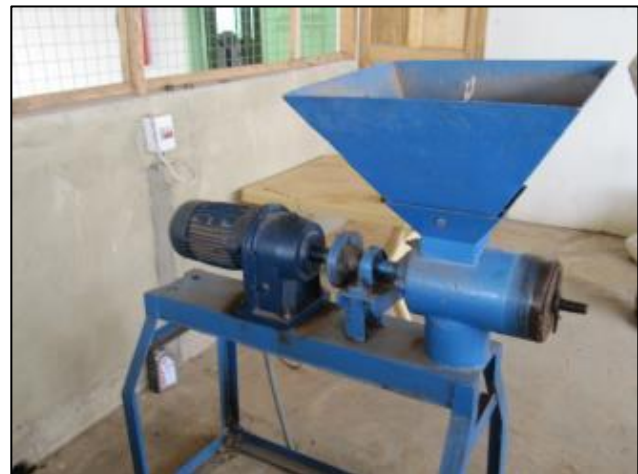
Peletizadoras en Uganda y Ghana (Fuente: Eawag-Sandec)
