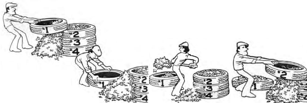
Unidad de compostaje de neumáticos reciclados (Fuente: www.tirecrafting.com )
