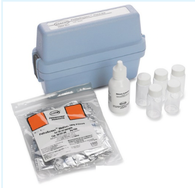
Kit d'analyse de terrain PathoScreen Source : Hach
