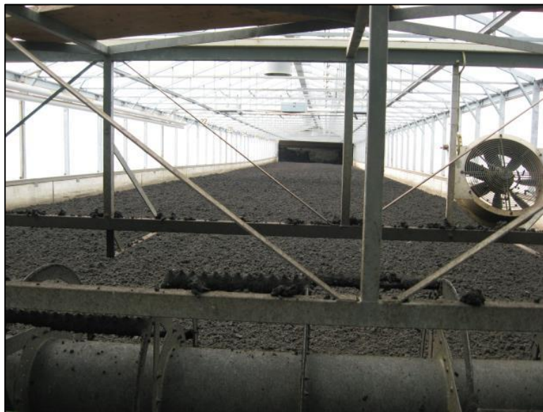
Un séchoir thermique est utilisé pour sécher les boues de vidange des eaux usées avant la combustion en Suisse (Source : Eawag-Sandec)
