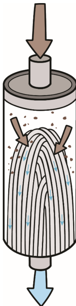
Figure 5 : exemple de membrane à fibres creuses. L'eau non traitée (flèche marron) pénètre dans la cartouche et passe à travers les minuscules pores des parois des fibres creuses. L'eau traitée (flèche bleue) s'écoule ensuite par les fibres creuses jusqu'en dehors de la cartouche.
