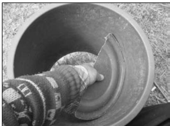
Paso 3. Conecte una mitad de la base a la mitad del balde utilizando alambre. La base debe estar en ángulo para que recolecte la orina.
