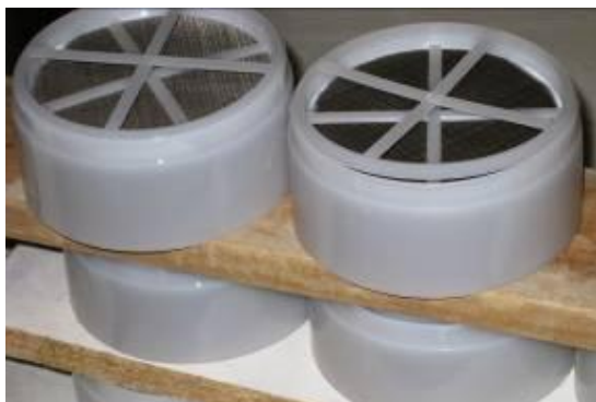
Placez les corps de tamis entre les planches
