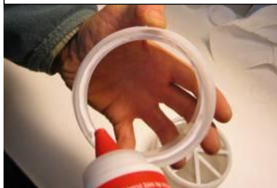
Étalez la colle sur le bord du corps du tamis
