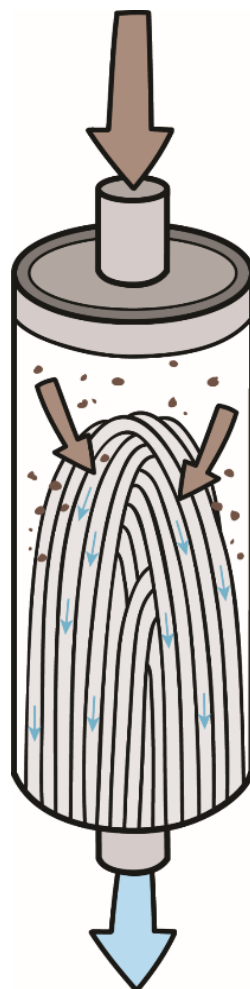
Figura 5. Ejemplo de una membrana de fibra hueca. El agua sin tratar (flechas marrones) se mueve dentro del cartucho y viaja a través de los poros diminutos de las paredes de las fibras huecas. El agua tratada (flechas azules) fluye a través de las fibras huecas y del cartucho.
