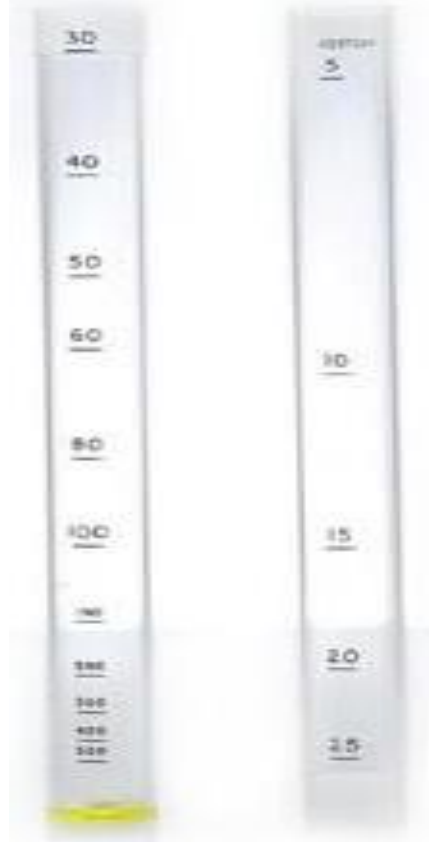
Tubo de turbidez de dos partes usado en un kit portátil
