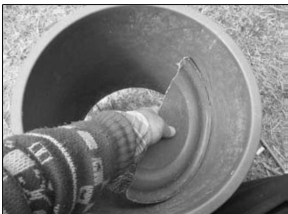
Étape 3. Attacher une moitié du fond à mi-hauteur du seau à l'aide d'un fil de fer. Le fond doit être incliné pour recueillir l'urine.
