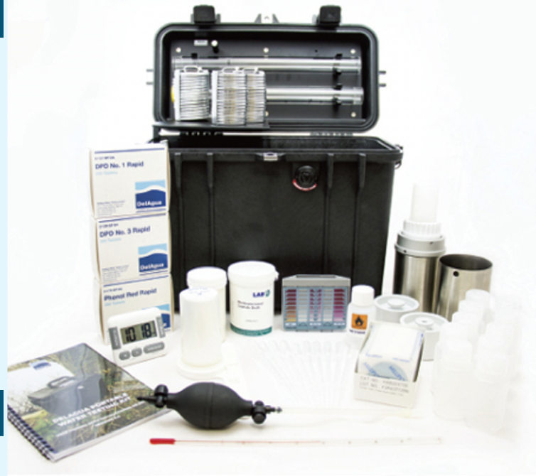
Kit d'analyse portable Delagua (source : Delagua)
