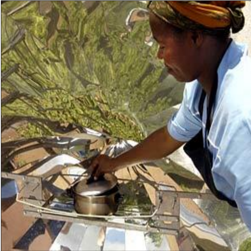
Usando un panel solar para pasteurizar agua (Crédito: www.smc.edu )
