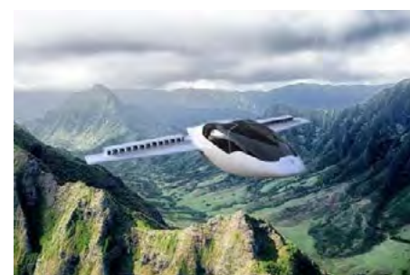
電動ジェットを多数装備した翼を持つリリウム。離着陸にはジェットの噴射が下向きになる。
