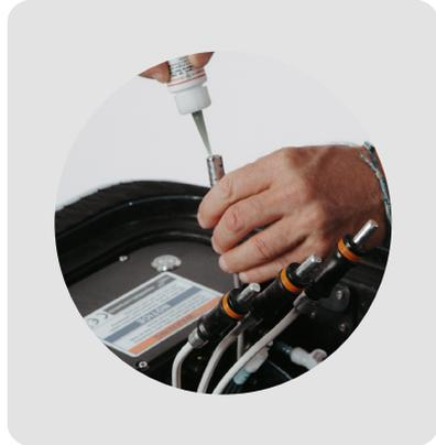
3. Retire la tapa de protección del puerto de la datos de la batería y conecte con cuidado el cable de datos. Asegúrese de escuchar el "click" una vez colocado en el sitio correcto. Recuerde: emitirá un sonido "click" al encajar. El conector de datos viene codificado así que solo funcionará si los puntos rojos están alineados.
