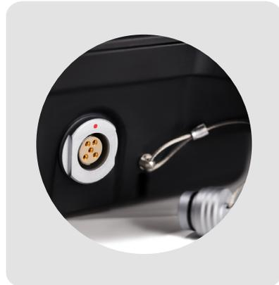
**⚠ PRECAUCIÓN:** Este cable de datos utiliza puntos de contactos eléctricos sensibles que transmiten información crítica al eBox. Es importante mantener éste conector y sus "pins" en perfecto estado y alejado del agua salada o residuos.
