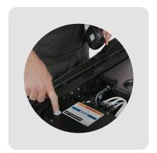
2. Verbinden Sie den Stromanschluss mit dem Akku, indem Sie die Nockenverriegelung über den Stift schieben; üben Sie Druck nach vorne aus und drehen Sie die Nockenverriegelung um 90 Grad, um sie einzurasten.
