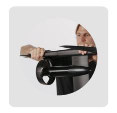
Montieren Sie die Tragfläche mit zwei M6x30mm Schrauben und dem 4mm Inbusschlüssel am Mast.
