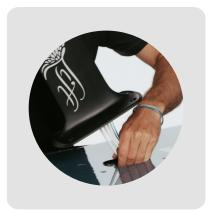
3. Sichern Sie den Mast mit beiden Händen und drücken Sie ihn fest nach unten, bis die Gummidichtung einrastet.
