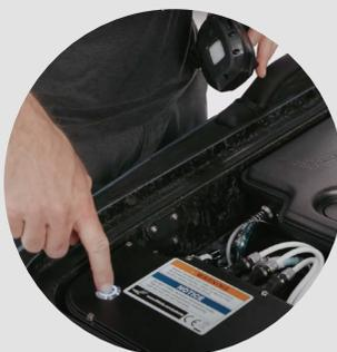
2. Verbinden Sie den Stromanschluss mit dem Akku, indem Sie die Nockenverriegelung über den Stift schieben; üben Sie Druck nach vorne aus und drehen Sie die Nockenverriegelung um 90 Grad, um sie einzurasten.
